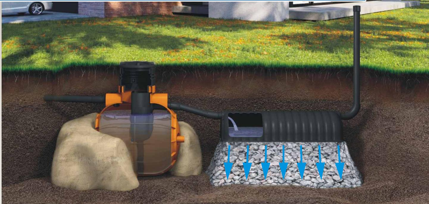
РАБОТА СИСТЕМЫ ОСНОВАНА НА КЛАССИЧЕСКОМ МЕТОДЕ ОЧИСТКИ — осаднении и биологической доработке (биохимическом разрушении микроорганизмами органических веществ), после чего очищенные стоки рассеиваются через грунт. Системы **БИОСТОК** можно установить в почве различных типов, в том числе в суглинке, глине, песке и торфе, где она всегда будет работать эффективно.
