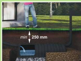
Для возможности заезда легковым автотранспортом, минимальный слой засыпки грунта должен быть не менее **500 мм**. Если, зона под дренажом предназначена только для ходьбы, то слой грунта может быть **250 мм**. При этом необходимо учитывать региональную глубину промерзания грунта или произвести утепление.
